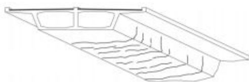
[그림 1.9] PSC 박스거더의 균열
